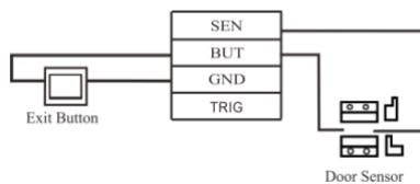
Door sensor/Exit button – Дверной сенсор/Кнопка выхода
