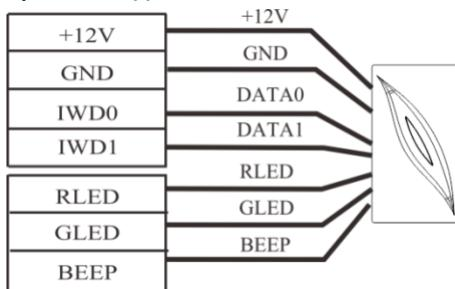
В устройстве есть функция Wiegand входного сигнала (ин). Речь про возможное подключение к независимому карту ридера. Устанавливаются на каждой стороне двери, чтобы контролировать замок/доступ вместе.
